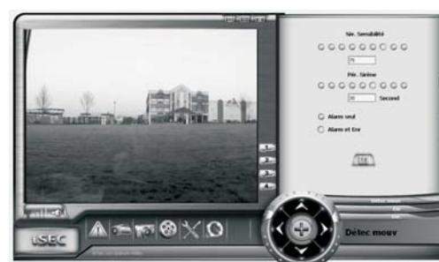
Avec ce type d'enregistrement automatique, le logiciel évalue les modifications dans l'image sélectionnée pour détecter les mouvements dans l'image. S'il détecte des mouvements, un signal sonore peut être émis par le PC et un enregistrement peut être effectué.
