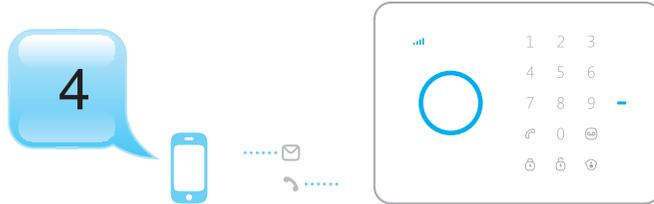
Senden Sie eine SMS mit '4' an die SIM-Karten-Nummer, die Zentrale ruft zurück. Nehmen Sie den Hörer ab, und sprechen Sie eine max. 10-sekündige Nachricht nach einem Piepton auf.
