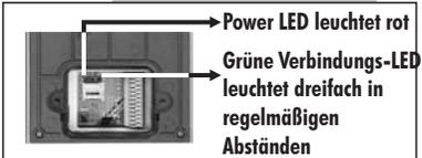
Falls LED nicht dreifach blinkt, Hardreset durchführen (Reset-Taste für eine Minute gedrückt halten)
