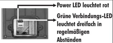
Falls LED nicht dreifach blinkt, Hardreset durchführen (Reset-Taste für eine Minute gedrückt halten)
