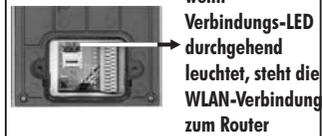
wenn Verbindungs-LED durchgehend leuchtet, steht die WLAN-Verbindung zum Router
