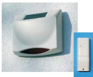
Die Funk-Außensirene wird geliefert mit einem Funksender, der an den MA 80 angeschlossen wird. Die Sirene selbst wird über Solar betrieben und ohne jegliche Kabelanschlüsse an einem geeigneten Ort montiert. Die Sirene hat 115 dB(A) Lautstärke und ein Alarm-Blitzlicht hinter einer roten Blende.
